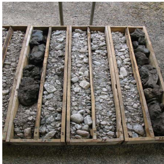
Probte Hauptterassen-Schotter einer Erkundungsbohrung für die Erweiterungsfläche einer Kiessandlagerstätte bei Leipzig
