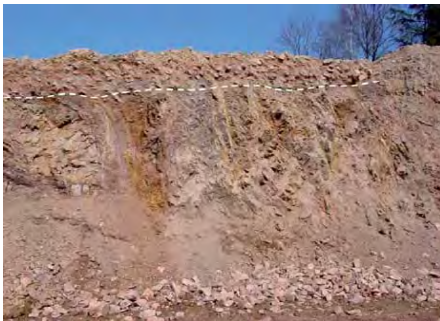
Beprobung eines Festgesteinstagebau im Osterzgebirge: Eine bis 1,5 m mächtige Schuttdecke aus Quarzporphyr (oben; schon teilweise abgetragen) überzieht hangabwärts weitflächig das stark verwitterte Gneis-Nebengestein (unten) und täuscht oberflächlich eine größere Ausdehnung des Rohstoffs Quarzporphyr vor (Foto: Lobst, LfULG)
